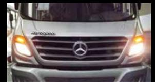
Mejor acceso frontal para mantenimiento; no es necesario desensamblar los faros principales para hacer cambio de filtro
