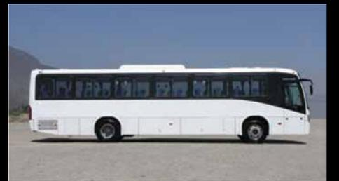
El diseño innovador de la carrocería cuenta con faldones modulares, formados por paneles móviles que permiten un excelente mantenimiento y acceso a los componentes del chasis; además de permitir la rápida y fácil reposición en caso de daño por accidentes.
