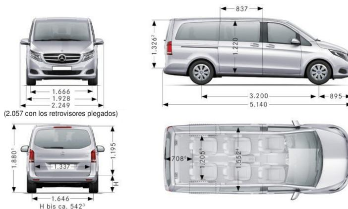
Legenda del dibujo: Todos los datos en mm. \*La altura del vehículo aumenta en 48 mm en combinación con el equipo opcional barras longitudinales en el techo. <sup>2</sup>Altura interior. <sup>3</sup>Sin carga. Anchura máxima del espacio de carga/habitáculo (medida en el piso). Anchura interior entre los pasaruedas. <sup>4</sup>Medido en el piso del vehículo. <sup>5</sup>2.060 mm con los retrovisores plegados. Diámetro de giro aprox. 12.2 m.
