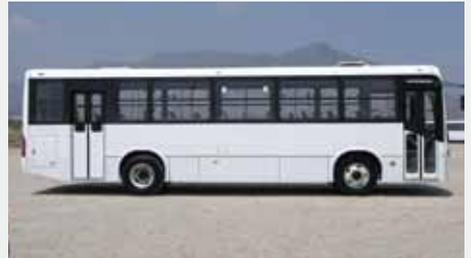
El diseño innovador de la carrocería cuenta con faldones modulares formados por paneles móviles, que permiten un excelente mantenimiento, acceso a los componentes del chasis y bajo costo de mantenimiento.
